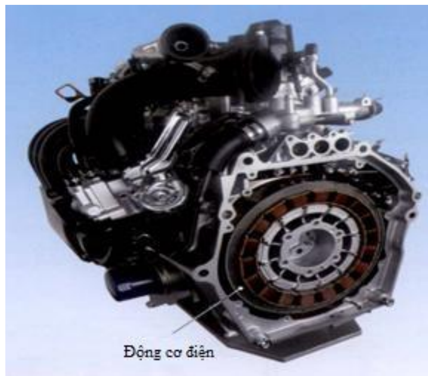
Hình 3. 20. Động cơ và hộp số hệ thống Hybrid song song
